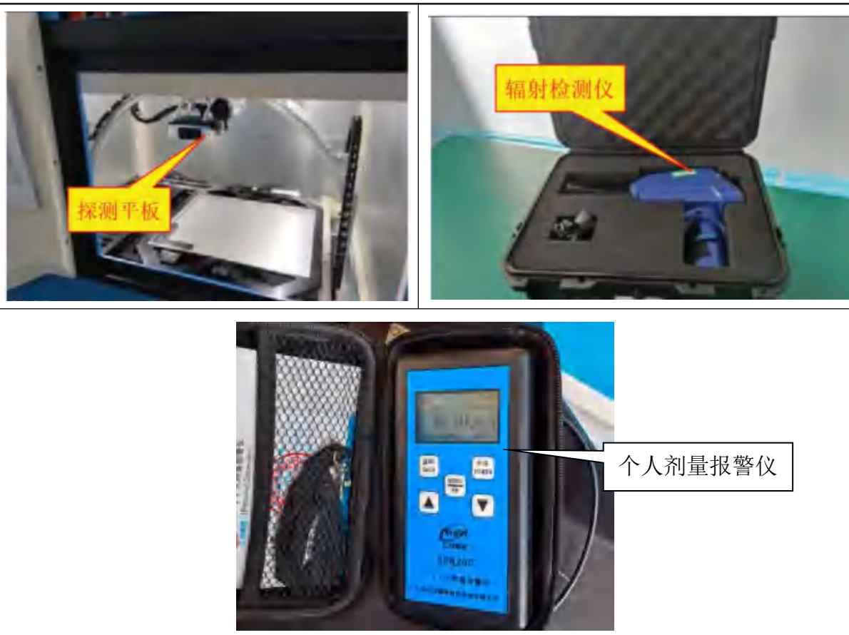
图 10-4 X 射线检测仪（制造一部拟搬迁设备）辐射安全防护设施现场照片
