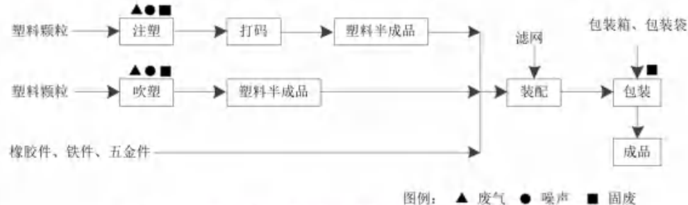
图 2-3 初级过滤器生产工艺流程及产污环节图
